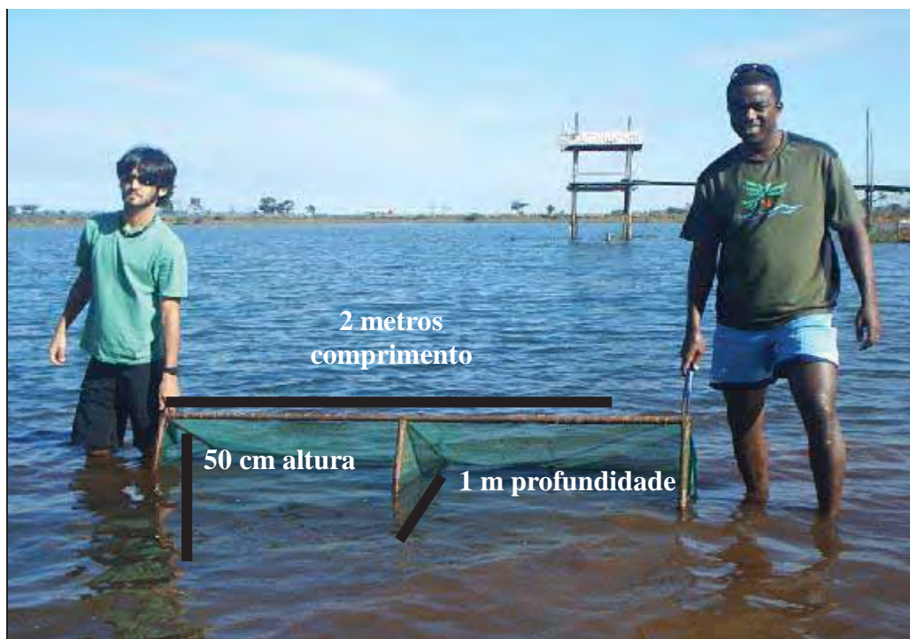
Figura 6 - Coletor de camarões com armação de metalon e tela de nylon, arrastado nas margens.
