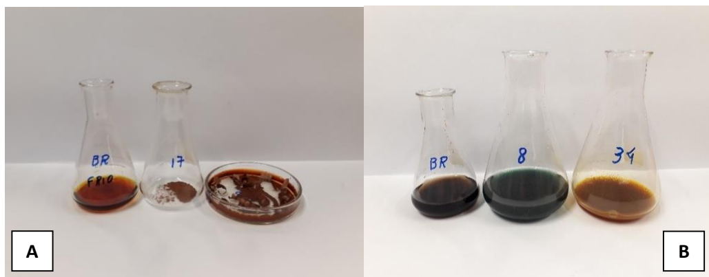
Figura B – Placa de petri com a fração humina seca em estufa à 45 °C, frasco Erlenmeyer com amostra macerada para ser oxidada e amostra da prova em branco oxidada, da direita para esquerda – (A). Sequência de cores durante a titulação das amostras de humina, da direita para a esquerda – (B). Botucatu, SP
