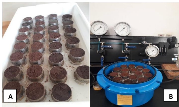
Figura D – Anéis volumétricos saturando em água – (A); e amostras na câmara de Richards – (B), Botucatu, SP
