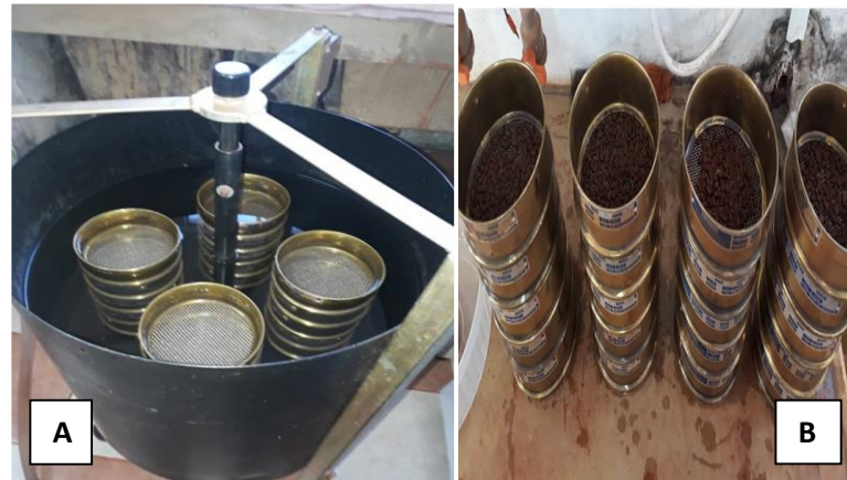
Figura C – Aparelho de oscilação vertical – (A); e amostras após tamisamento em água – (B), Botucatu, SP
