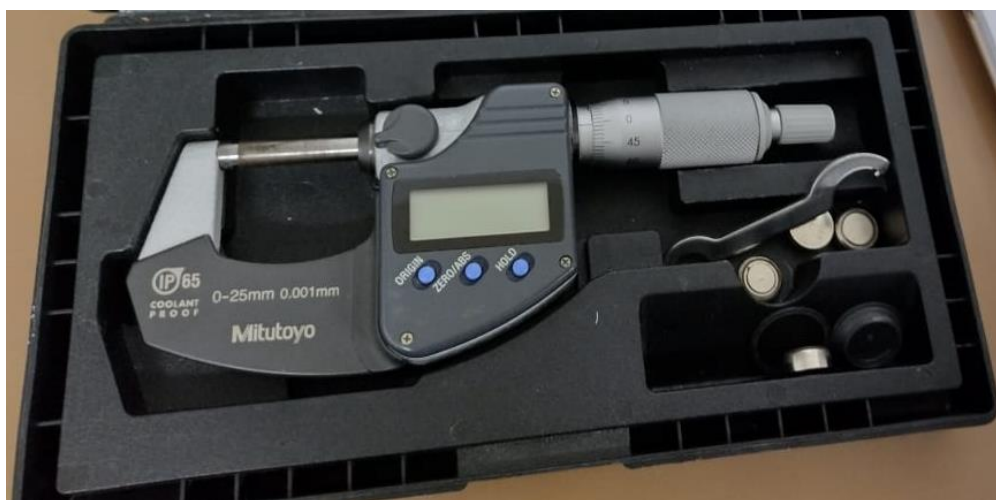
Figura 9: Micrometro utilizado para medir a espessura dos filmes
