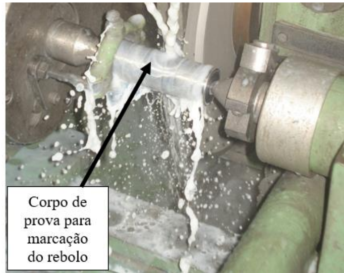
Figura 23: Processo de marcação do rebolo.
