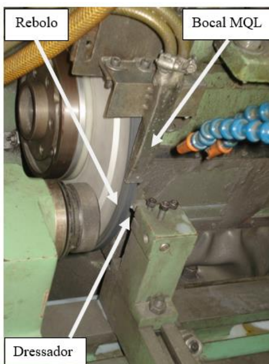
Figura 21: Operação de dressagem do rebolo.
