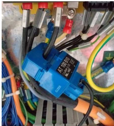
Figura 16 - Ligação do sensor de potência acoplado na entrada do motor de rotação do centro de torneamento CNC.
