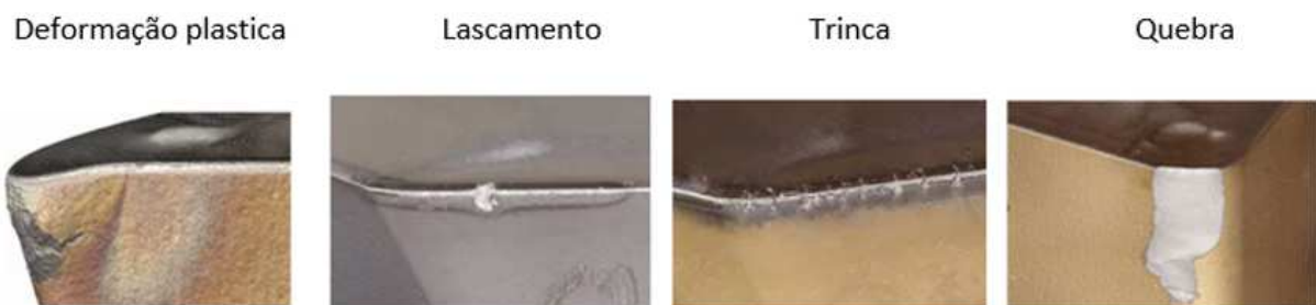
Figura 11- Avarias nas ferramentas de corte.
