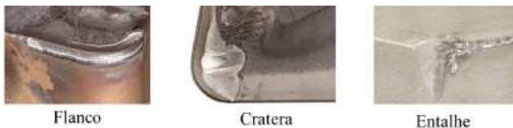
Figura 10- Desgastes nas ferramentas de corte.
