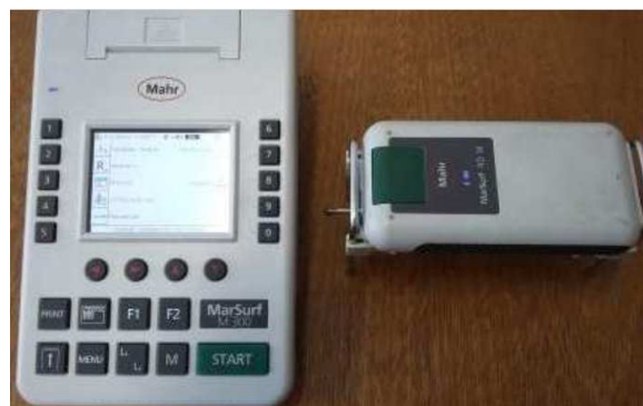
Figura 18– Rugosímetro portátil da MAHR modelo MarSurf M300 + RD18
