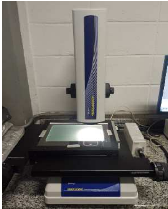
Figura 23– Microscópio marca Mitutoyo modelo QS-LBZ -Visual QUICK SCOPE série 359.
