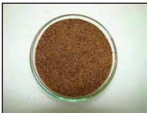
Figura 11 - Fibras de casca de banana prata trituradas e peneiradas
