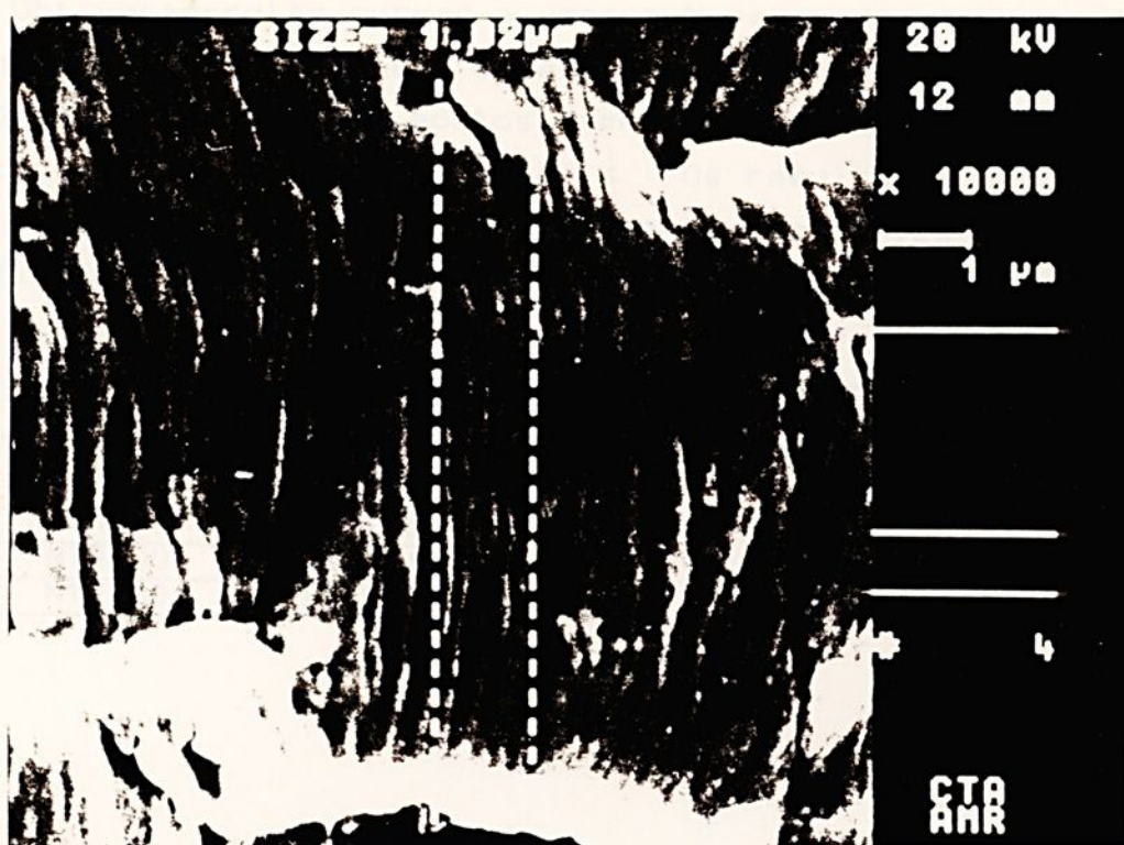
Figura 5.35 - Estrias de fadiga na região de propagação estável.
