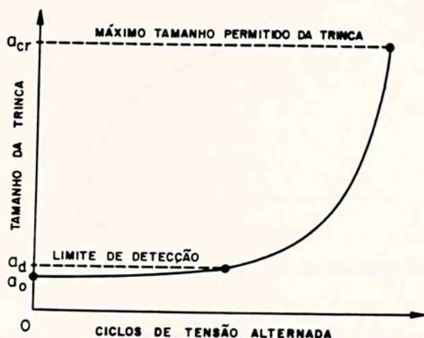
Figura 2.9 - Curva esquemática de propagação da trinca por fadiga.
