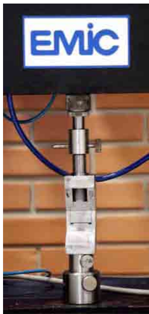
FIGURA 12 – DISPOSITIVO DE MICROTRAÇÃO ACOPLADO À MÁQUINA DE ENSAIOS MECÂNICOS
