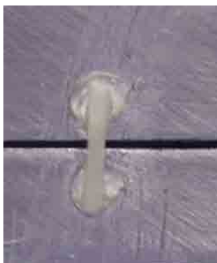
FIGURA 11 – ESPÉCIME FIXADO AO DISPOSITIVO DE MICROTRAÇÃO.
