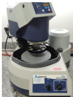
5. Planificação da dentina e polimento do esmalte em politriz
