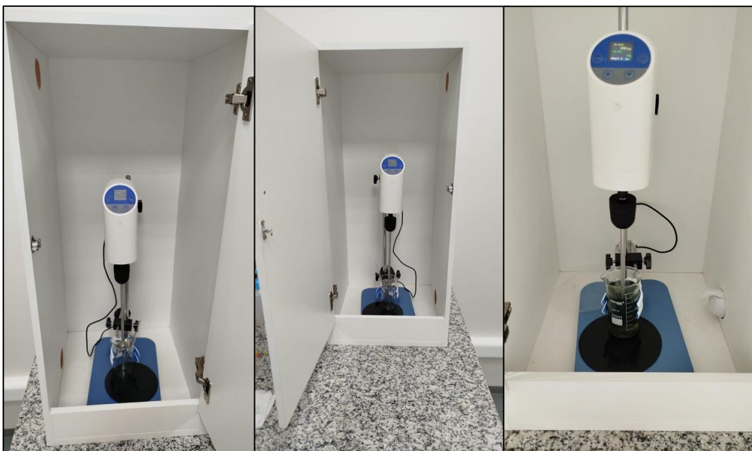
Figura 17: Sistema de Agitação Mecânica para Adsorção e Obtenção do Híbrido mNGO@ICG. Fonte: Próprio autor
