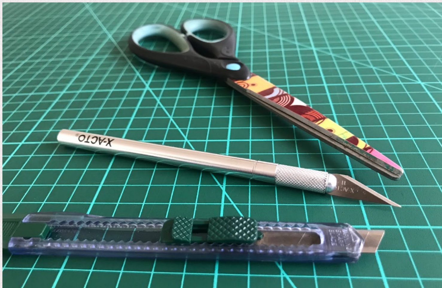
Figura 29: Ferramentas que usei para recortar. De baixo para cima: estilete comum pequeno, estilete de precisão X-Acto com lâmina modelo nº11, e tesoura comum. Ao fundo, em verde, a base para corte.
