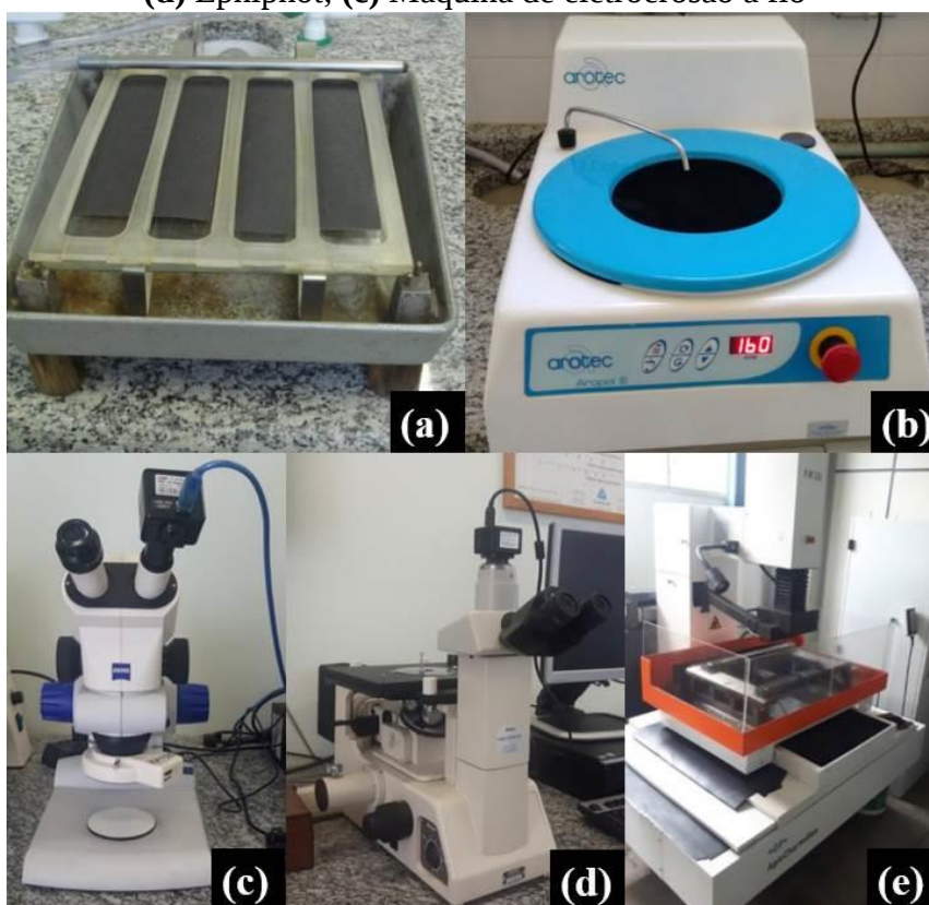
Figura 24 – Equipamentos utilizados na confecção e preparação dos corpos de prova e na análise metalográfica dos mesmos (a) Lixadeira; (b) politriz; (c) Microscópio Estéreo; (d) Ephiphot; (e) Máquina de eletroerosão a fio
