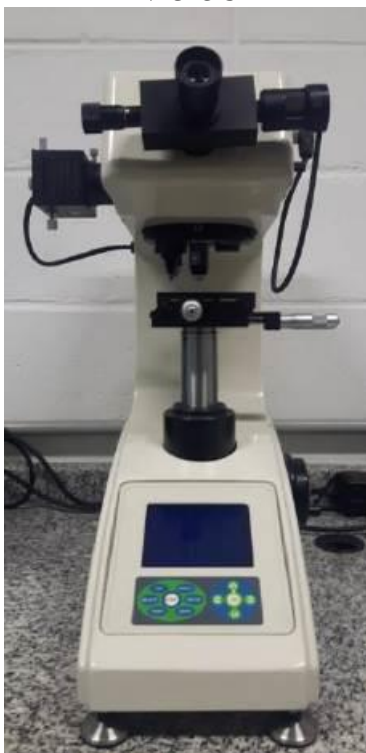
Figura 25 - equipamento Microdurômetro WOLPERT com penetrador de diamante Vickers
