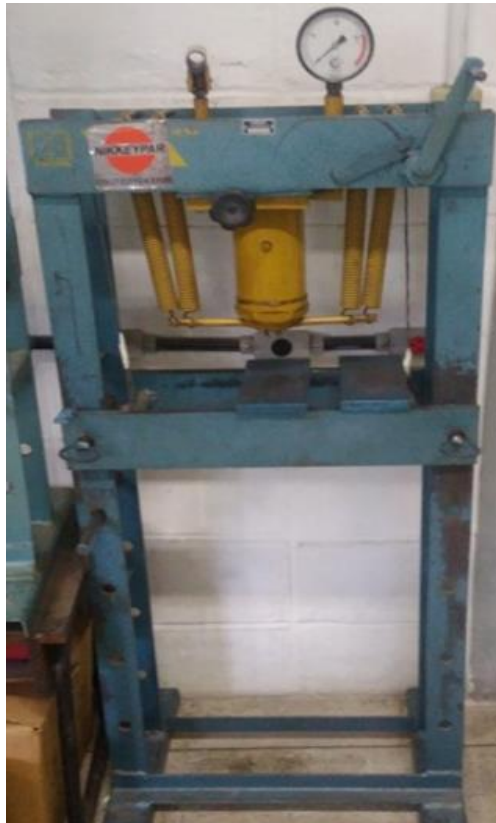
Figura 9 - Prensa Hidráulica utilizada para realização dos ensaios de prensagem uniaxial.
