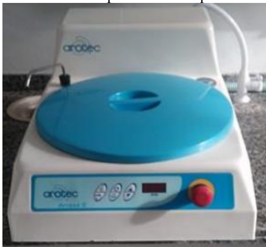
Figura 14 - Equipamento utilizado para realizar o polimento das amostras
