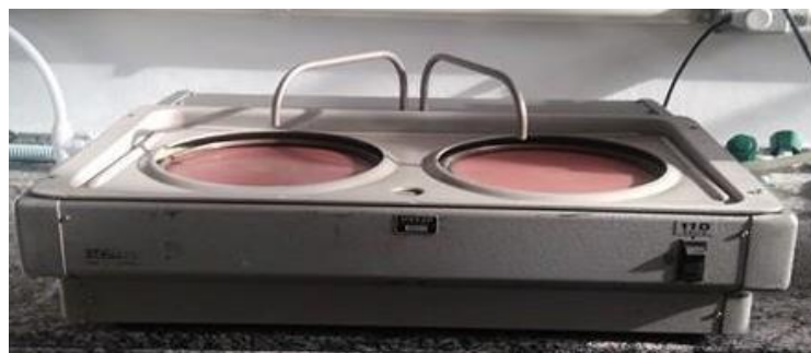
Figura 12 - Equipamento utilizada para realizar o lixamentos das amostras
