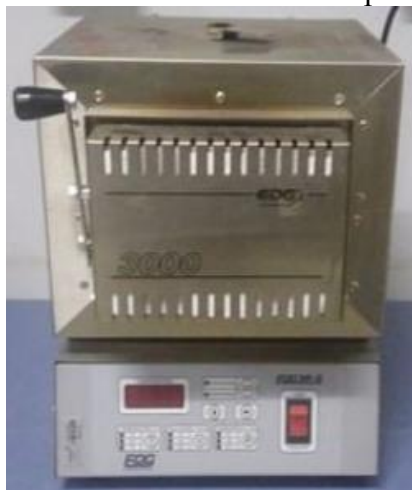
Figura 8 - Forno convencional modelo EDG 3000 utilizado para calcinação das amostras
