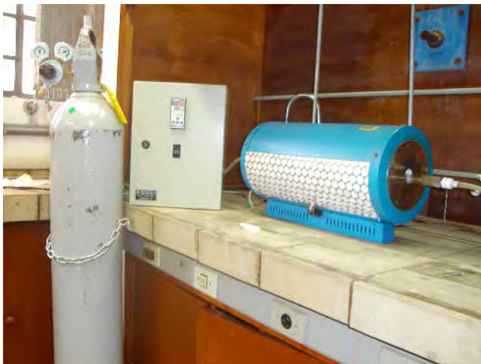
Figura 1.6: Equipamentos que compõe o sistema de tratamento térmico.
