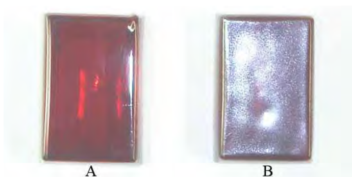
Figura 3.1: Resina polimerizada utilizando como catalisador: A) Solução 0,50 \text{ mol L}^{-1} de NaOH; B) Solução 0,5 \text{ mol L}^{-1} de HCL.
