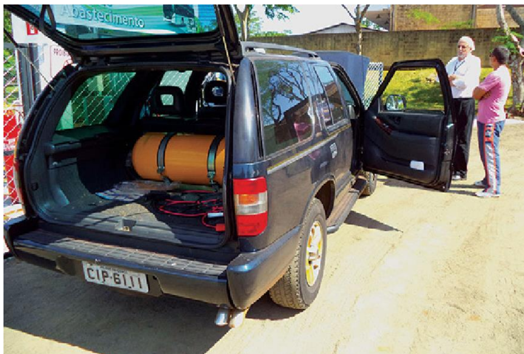
Figura 17 - Cilindro de armazenamento de biometano em veículo particular Fonte: Bley Jr (2015).
