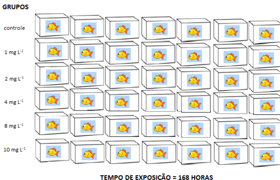
Figura 18 - Esquema do ensaio de toxicidade aguda
