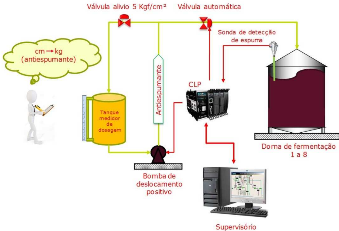
Figura 11. Estrutura de dosagem de antiespumante. Fonte: próprio autor.
