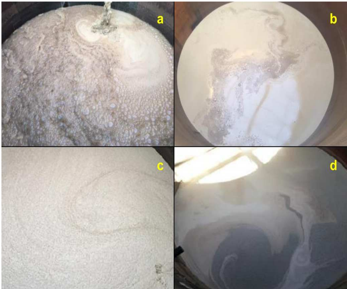
Figura 23. Aspecto visual da formação de espuma nas cubas de fermento tratado em processo industrial de produção de bioetanol. (ac) Período Controle, sem preparado enzimático. (bd) Período Enzima, com preparado enzimático. (ab) Ensaio 1. (cd) Ensaio 2. Fonte: Autor próprio.
