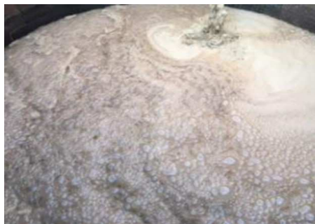
Figura 2. Formação de bolhas em dornas de processo industrial de produção e bioetanol. Fonte: próprio autor.
