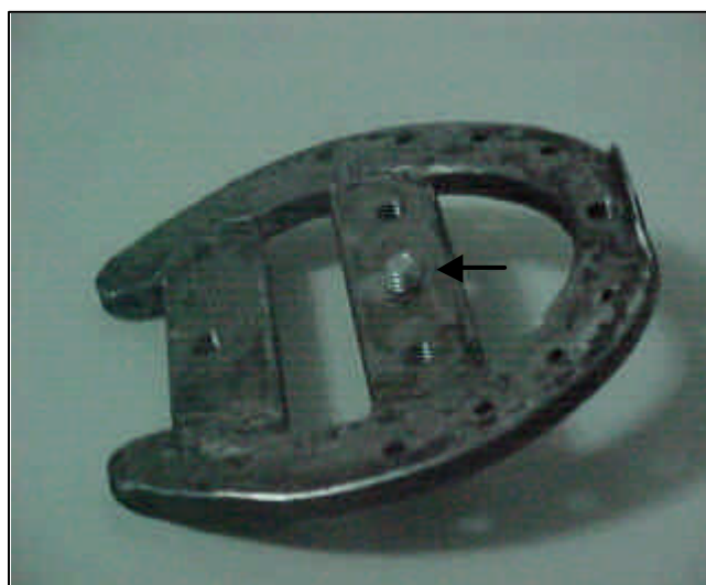
Figura 2. Extremidade do parafuso de \phi 6 mm, emergindo através do orifício central da barra, correspondendo ao ponto r (seta).
