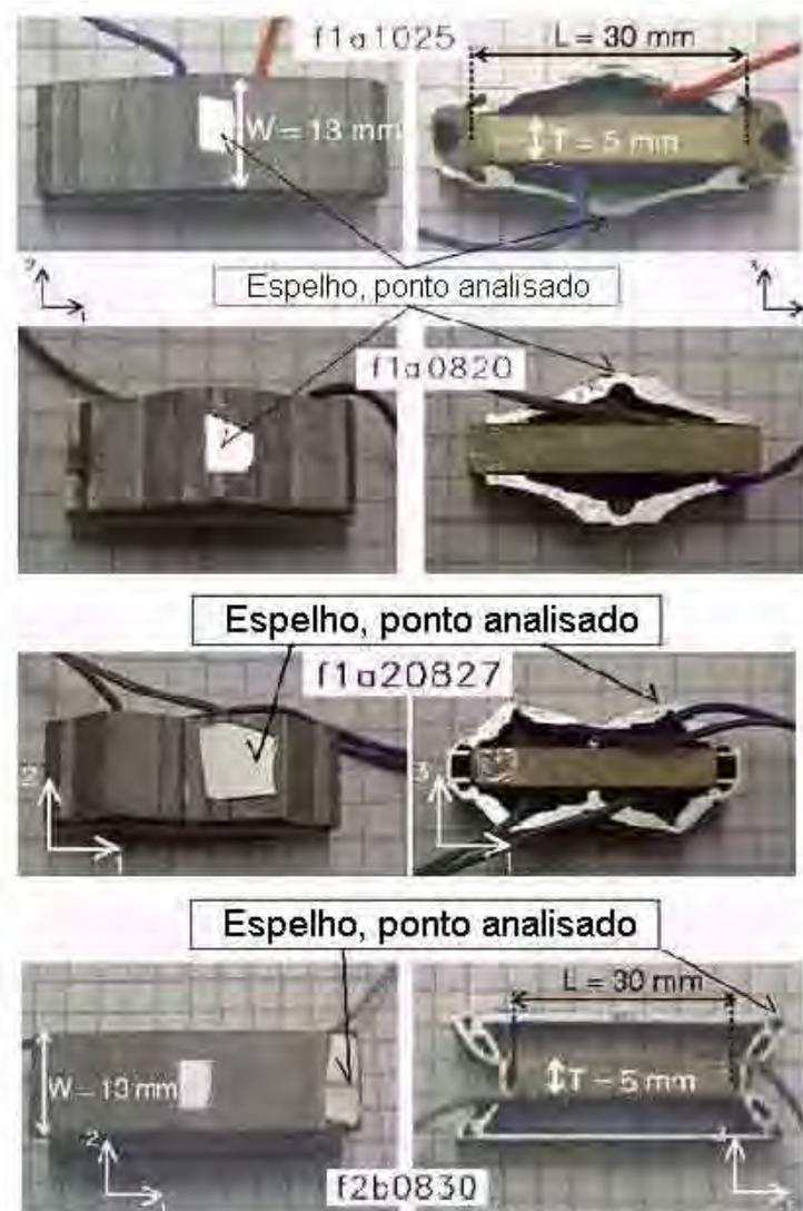
**Fig 3.26** – Piezoatuadores flexensionais com diferentes topologias dependendo do ponto em que deseja-se amplificar a vibração [29].
