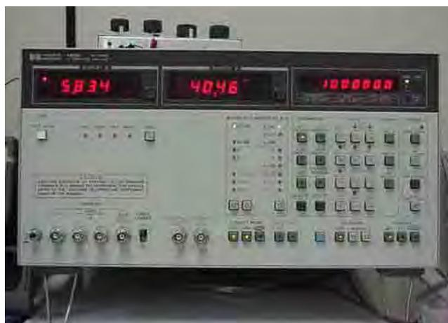
**Fig 4.14** – Analisador de impedâncias da HP modelo 4192A.
