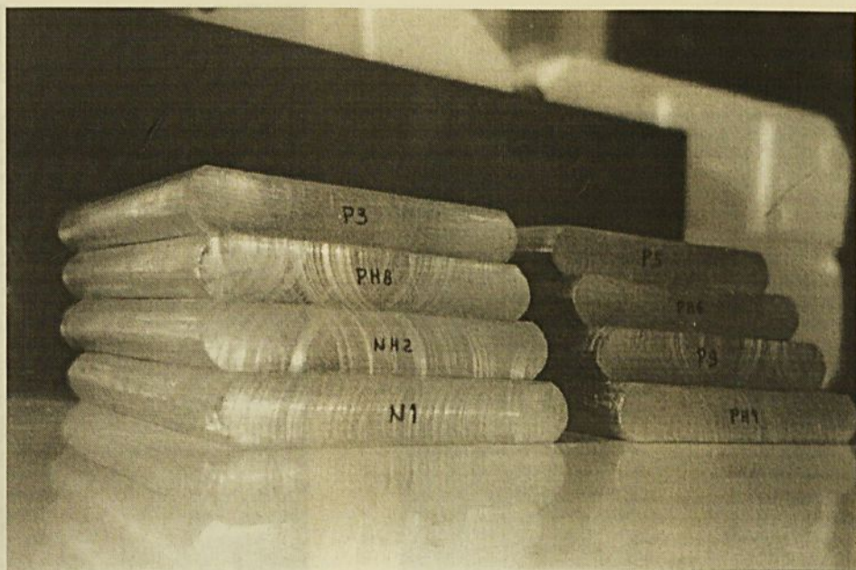
FIGURA 20 – Placas usinadas, prontas para a laminação a quente
