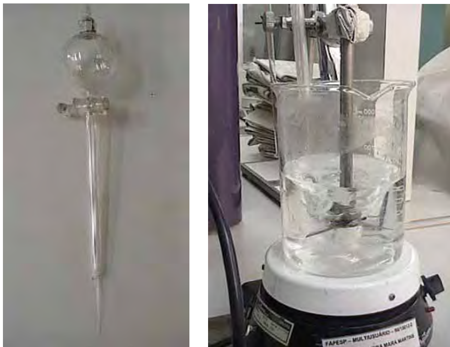
Figura 19. Funil de adição esterilizado e \text{CaCl}_2 gelado em agitação.
