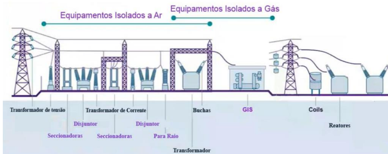
Figura 3 – Principais equipamentos de uma subestação de alta tensão
