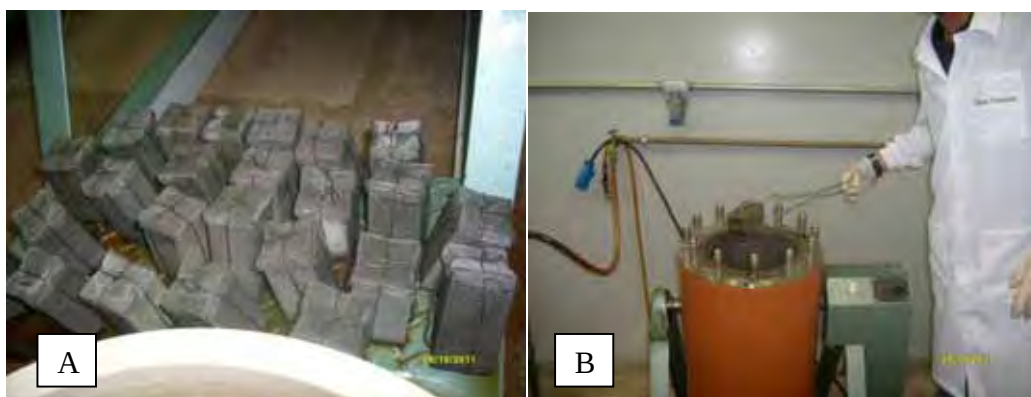
Figura 5. Processo de deslignificação Kraft; a) Cápsula utilizadas no armazenamento dos cavacos; b) Digestor rotativo
