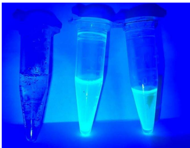
Figura 38: Fluorescência das soluções de quinolina dissolvidas em água, THF e acetona.
