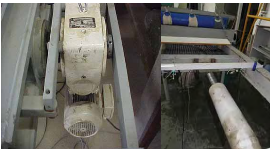
Figura 14 – À esquerda o motor elétrico e à direita o eixo do motor responsável pela tração do sistema.
