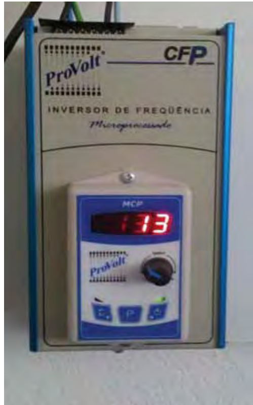
Figura 16 – Inversor de frequência
