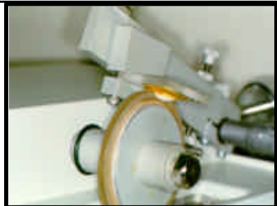
7. Secção da face vestibular no sentido transversal, na porção mais plana, utilizando-se 2 discos diamantados (série 15 HC Diamond - n. 11-4243 Buehler), montados em cortadeira sob refrigeração com água destilada/deionizada e separados por um disco espaçador de alumínio com 4 mm de espessura.
