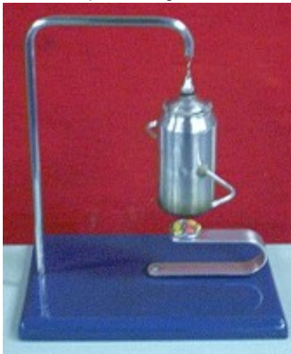
Figura 11: Ilustração da máquina térmica de Heron.
