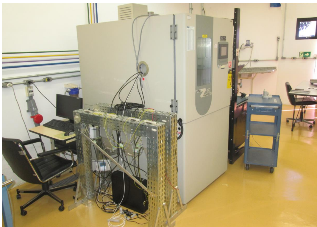
Figura 13a: Vista lateral da câmara climática utilizada na calibração do sensor de temperatura
