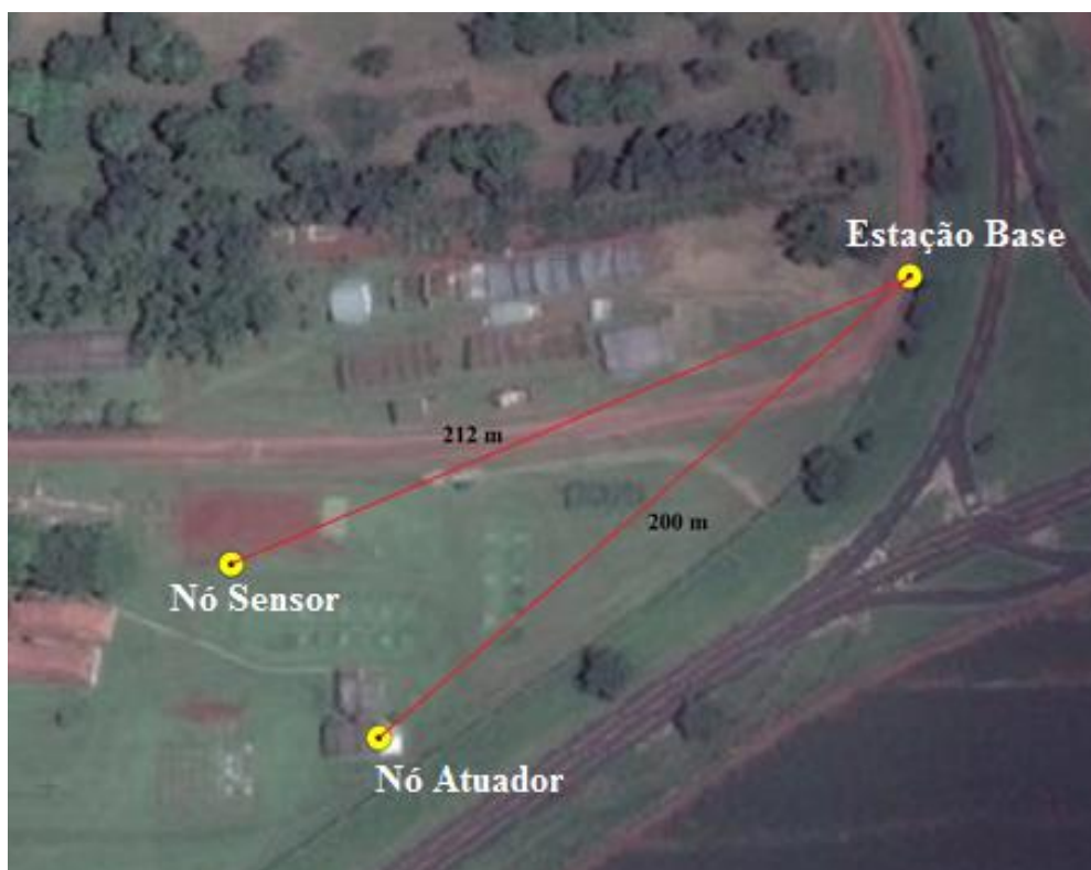
Figura 49: Representação geográfica dos pontos experimentais da avaliação de alcance entre os módulos
