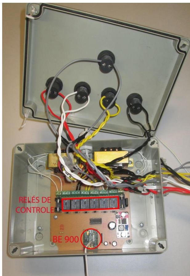
Figura 12b: Nó Atuador – vista interna
