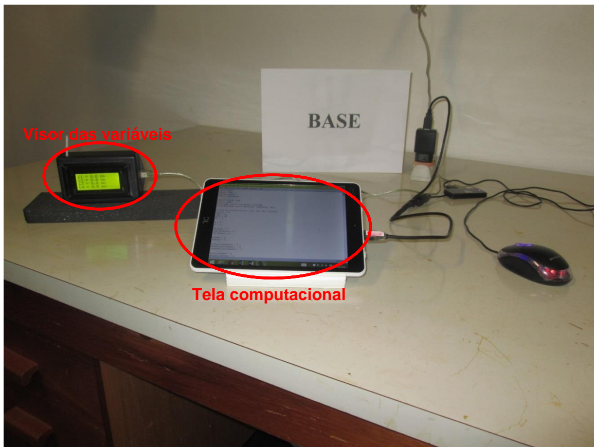
Figura 11a: Estação Base – Display visualizador das principais variáveis e software de controle
