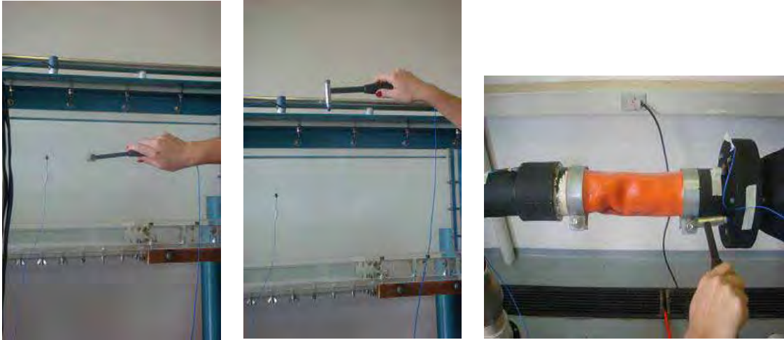
Figura A.8 – Local dos impactos com martelo instrumentado, nas direções X, Y e Z.
