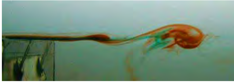
Figura 4.1 – Visualização por injeção de corante líquido do escoamento na camada cisalhante de uma cavidade com razão de aspecto \zeta = 4 e Re \approx 5000 .
