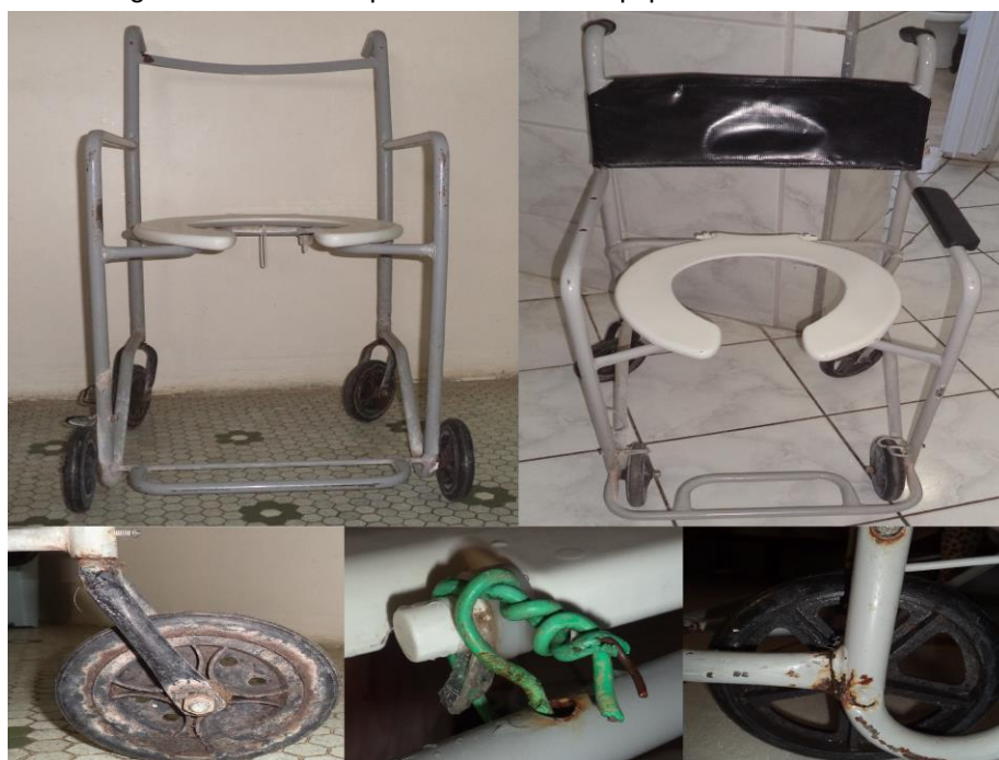
Figura 20 – Danos apresentados nos equipamentos
