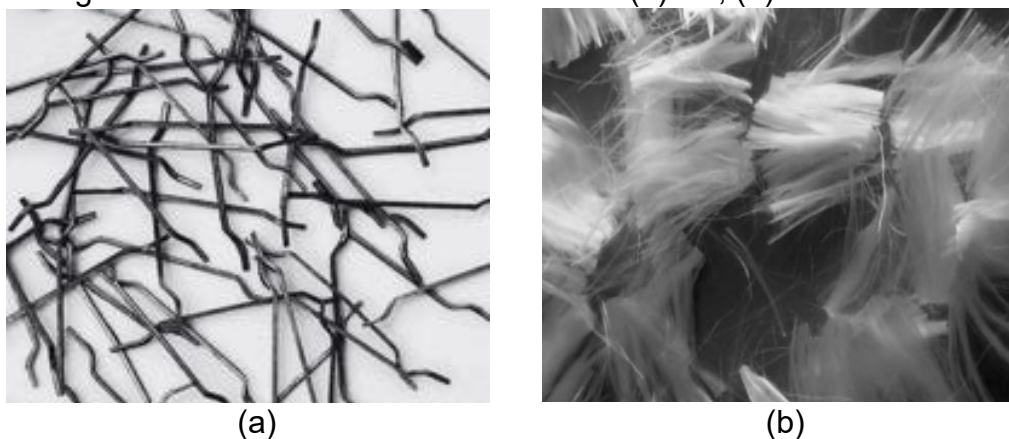
Figura 4 – Amostra das fibras utilizadas: (a) SF; (b) PP.
