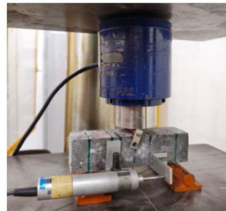
Figura 9 – Ensaio de resistência à tração na flexão: (a) esquema do ensaio; (b) ensaio no laboratório.
