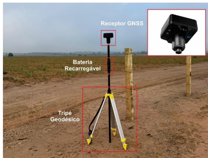
Figura 8. Estação móvel de alta precisão DJI D-RTK 2.
