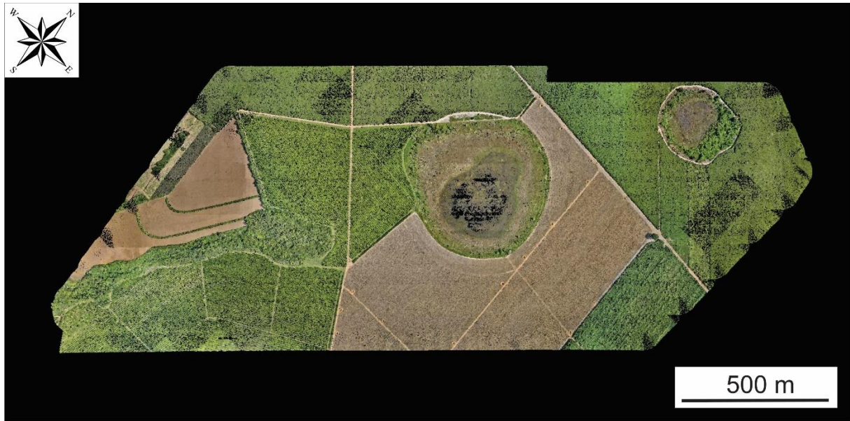
Figura 11. Visualização da nuvem de pontos em “Color Lidar by RGB/Elev”.
