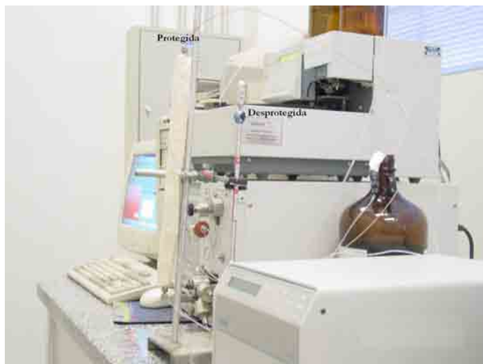
Figura 22: Coluna cromatográfica protegida contra variações da temperatura utilizando Isopor™.
