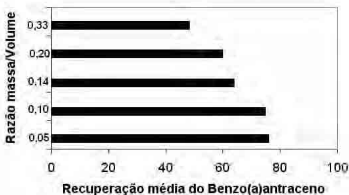
Figura 34: Extração do benzo(a)antraceno da rapadura com diclorometano.
