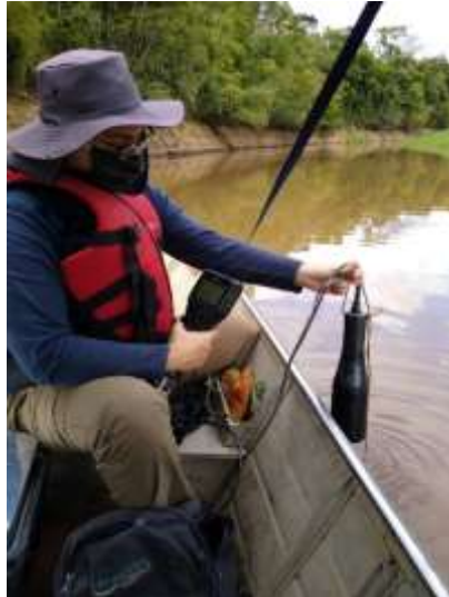
Figura 3 – Uso da sonda multiparâmetros no rio do Peixe. Foto: Bruna Quirici Urbanski, 2021.
