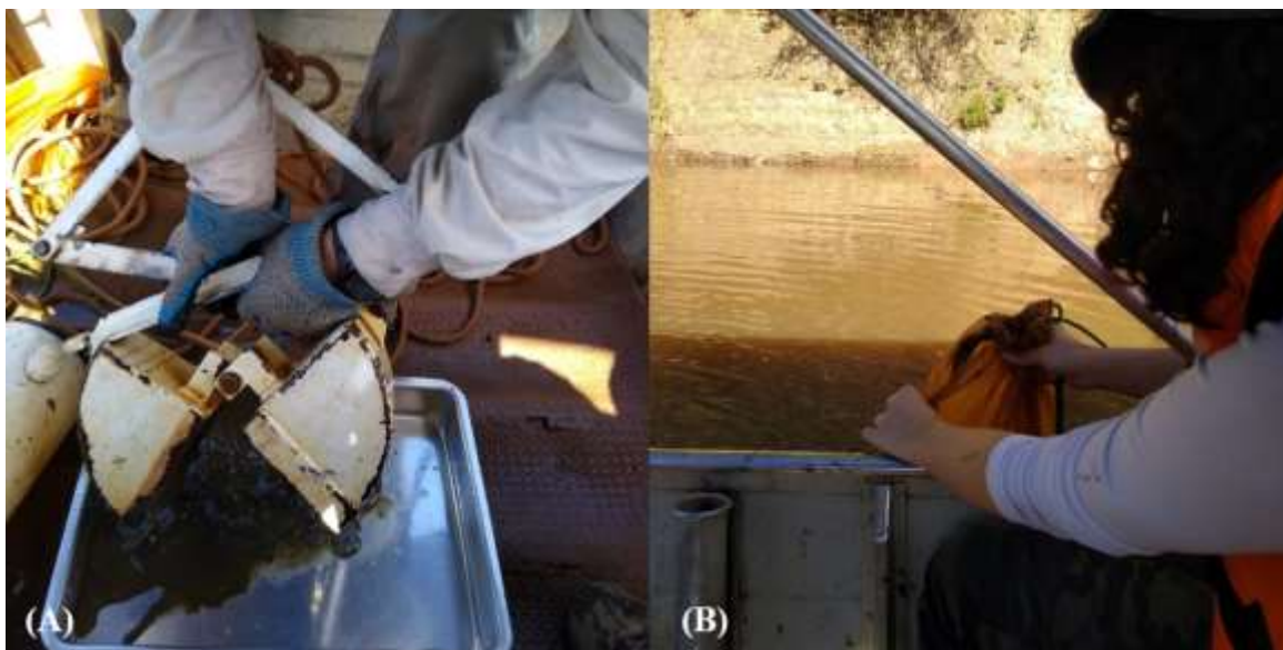
Figura 4 – Uso da Draga de Van Veen lavagem do conteúdo coletado em rede de 250 \mu\text{m} , no rio do Peixe. Fotos: Bruna Quirici Urbanski, 2021.
