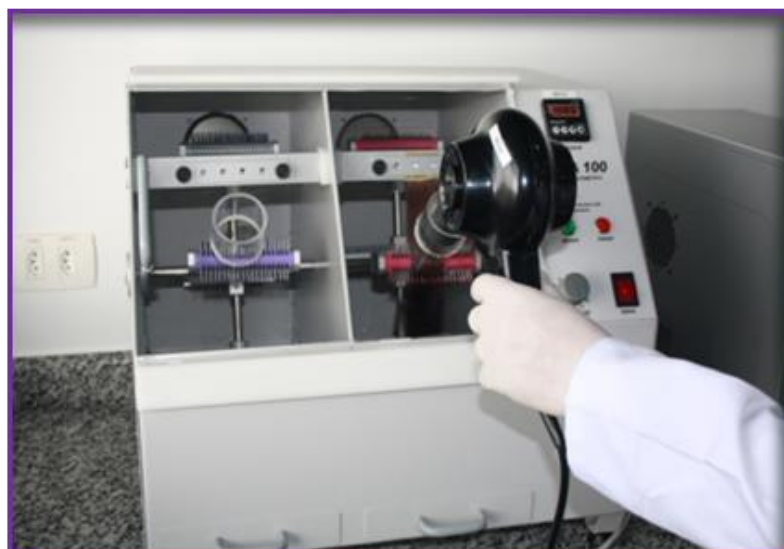
Figura 29. Sistema para avaliação da queda por quebra da fibra capilar – simulação de escovação por máquina de ciclos térmicos
