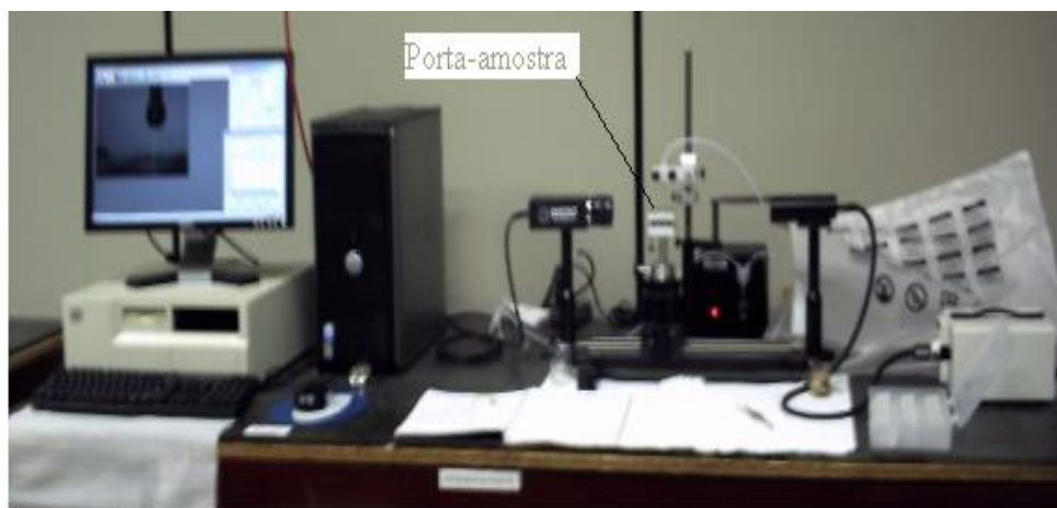
Figura 22 - Fotografia do sistema contendo goniômetro automatizado.
