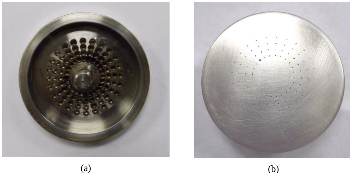
Figura 14 - Tampa que constitui a superfície do eletrodo superior: (a) interior e (b) exterior.
