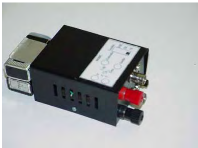
Figura 7.44 – Medidor de impedância de baixo custo (FURTADO; LOPES JR. (2005)).
