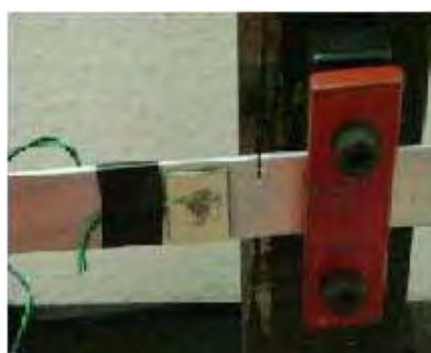
(c) Actuador Piezelétrico e posição da falha (elemento 1)
