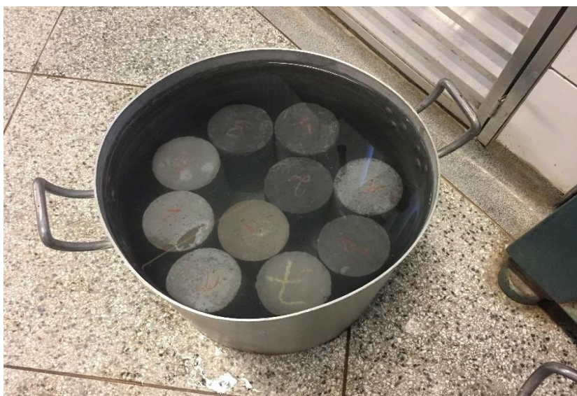
Figura 22 - Corpos de prova cilíndricos imerso em água
