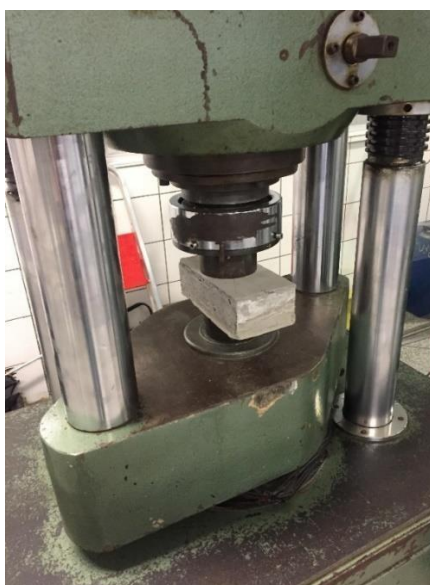
Figura 21 - Blocos de concreto sextavado submetidos a ensaio de resistência à compressão
