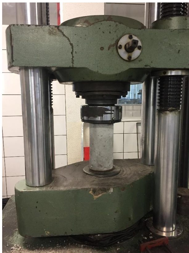
Figura 18 - Corpos de prova capeados com enxofre e submetidos ao ensaio de resistência à compressão.
