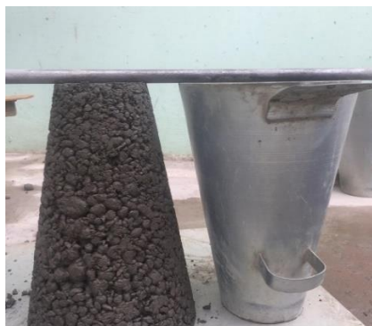
Figura 35 - Realização do teste de abatimento de tronco do cone
