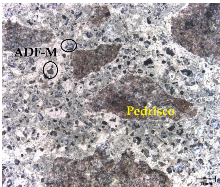
Figura 39 - Micrografia com ampliação nominal de 80x da área interna bloco de concreto sextavado
