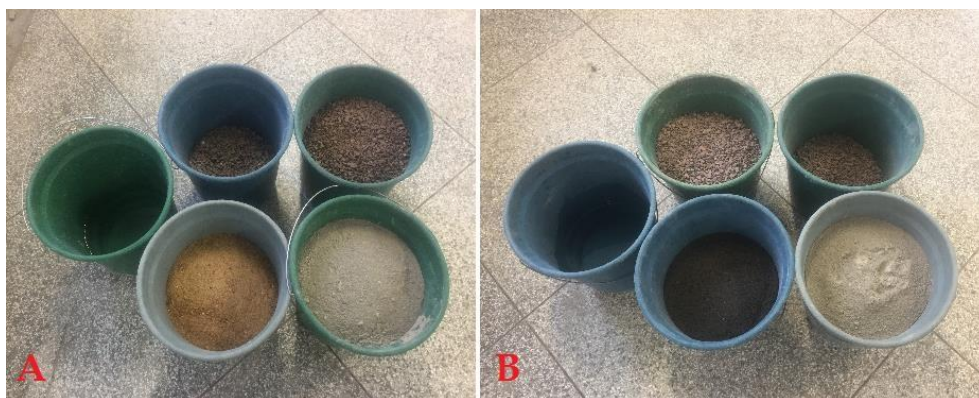
Figura 15 - Componentes do traço (A) referência e (B) ADF -M
