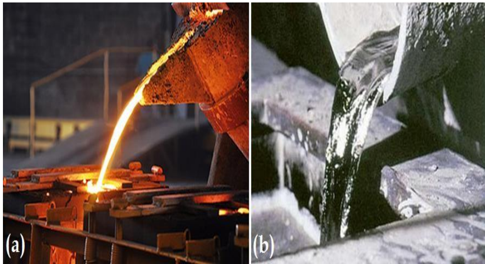
Figura 2 - Fusão do (a) Ferro Fundido e (b) Alumínio (BALDAM, 2013)
