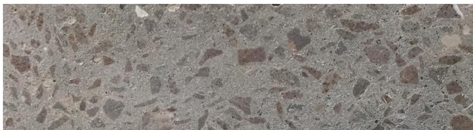
Figura 24 - Blocos de Concreto Sextavado cortado para análise de microscopia óptica
