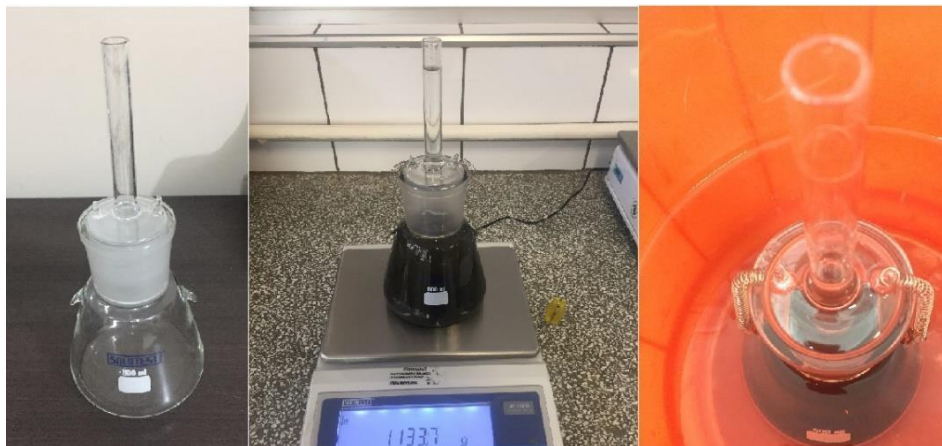
Figura 14 - Ensaio para determinar a massa específica das ADF e ADF-M.
