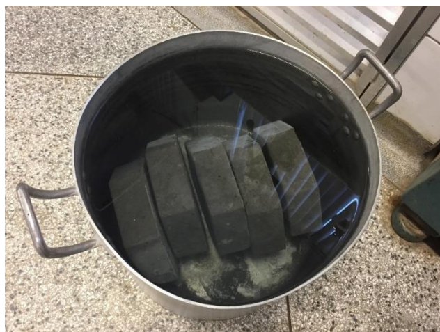
Figura 23 - Blocos de concreto imersos em água
