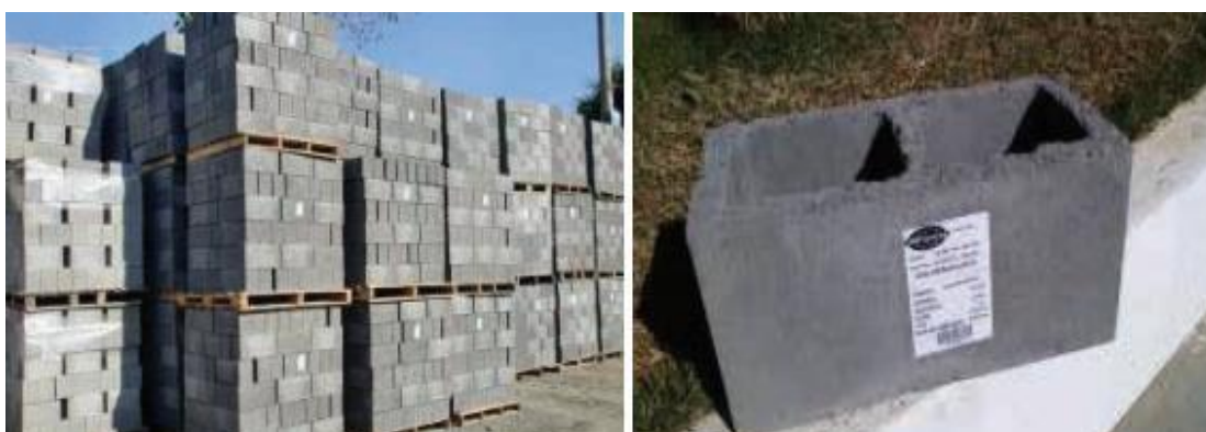
Figura 8 - A esquerda, depósito e a direita blocos de concreto com ADF (ART BLOCOS, 2014)
