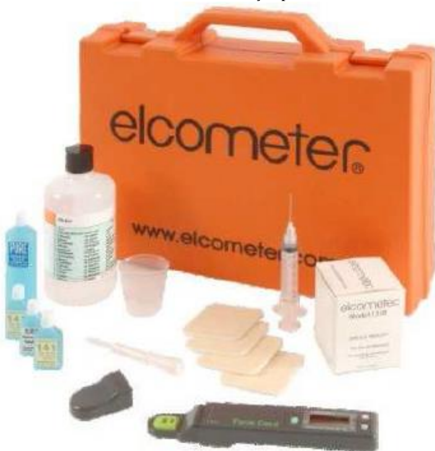
Figura 6: Kit Bresle, composto por solução de extração, seringa, agulhas, béquer, célula de teste de borracha, condutivímetro e solução padrão de condutividade.
