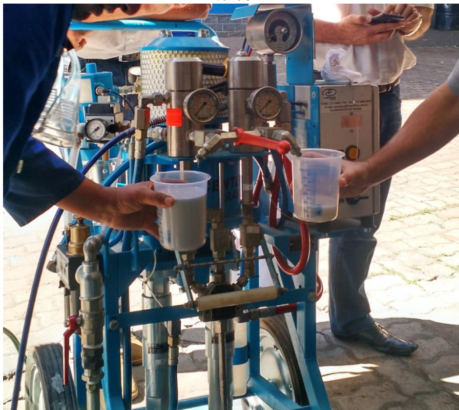
Figura 5: Equipamento de aplicação de tinta airless bicomponente. Bombas com diferença de vazão
