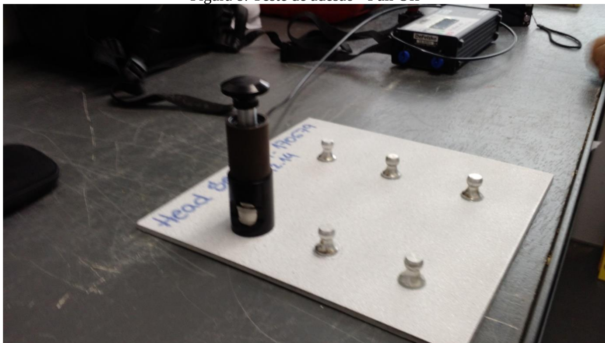
Figura 8: Teste de adesão - Pull Off
