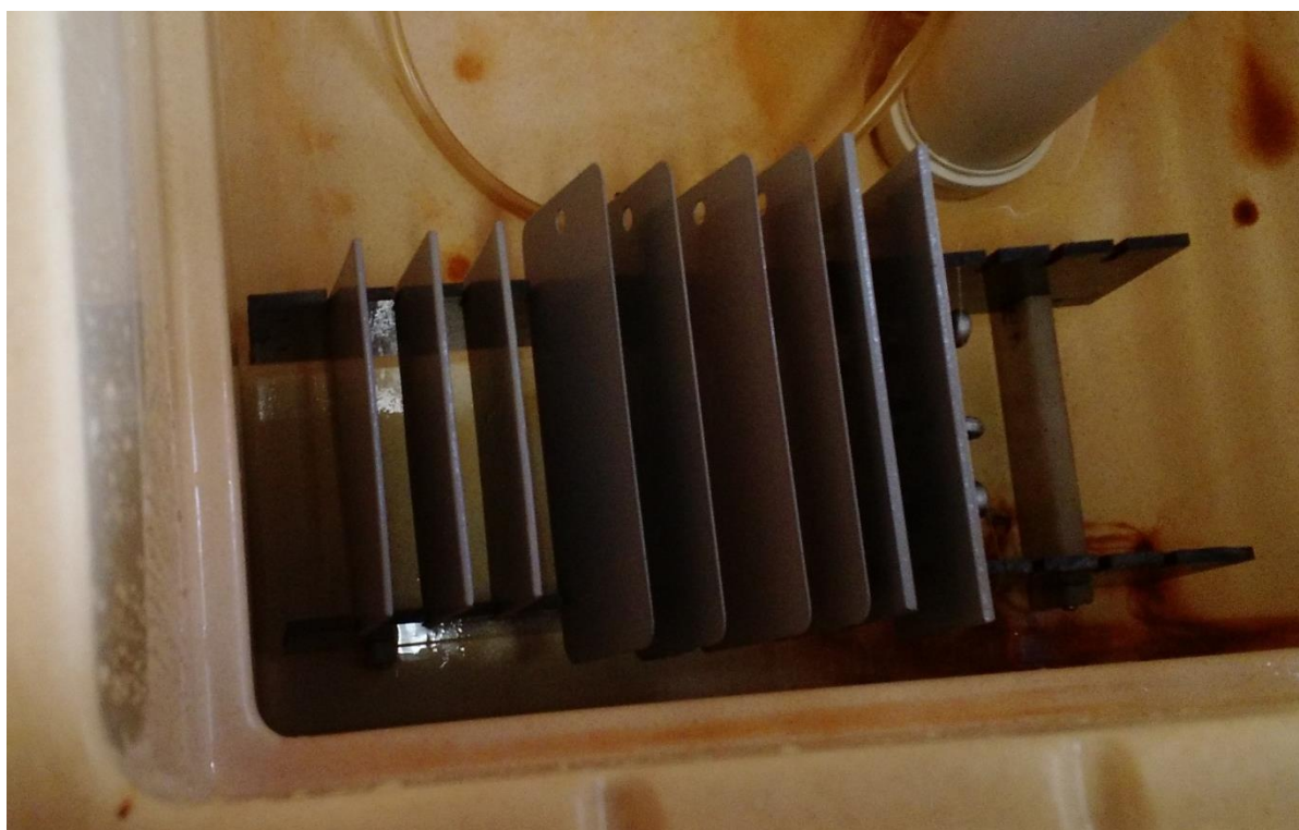
Figura 15: Posição dos corpos de prova dentro da câmara de Salt Spray
