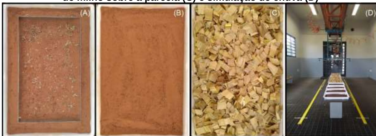
Figura 3 – Metodologia para semeadura das espécies com aro e distribuição das sementes (A), retirada do aro e cobertura com solo (B), colocação da palha de milho sobre a parcela (C) e simulação de chuva (D)
