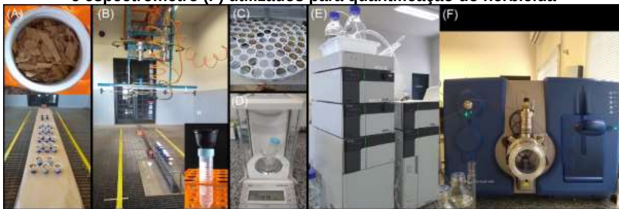
Figura 1 – Capsulas com palha de milho e alvos no momento da aplicação de 2,4-D (A), simulação de chuva e coleta da solução lixiviada (B), estrutura de quartzo (C), determinação do volume de chuvas coletado (D), cromatógrafo (E) e espectrômetro (F) utilizados para quantificação do herbicida
