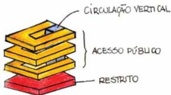
Figura 20 - Setorização e circulação do edifício.
