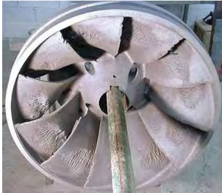
Figura 5 – Rotor de uma Turbina Francis com Cavitações (Fonte: METALINE 7 ).
