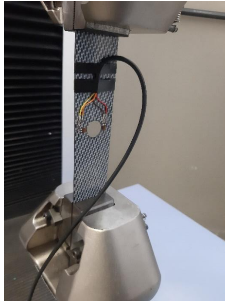
Figura 19. Montagem do CDP na máquina de tração.
