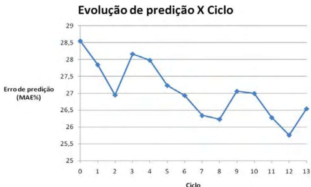
Figura 79 – Evolução de desempenho das melhores redes MLP a cada ciclo – aplicação do método aos resultados dos experimentos de usinagem
