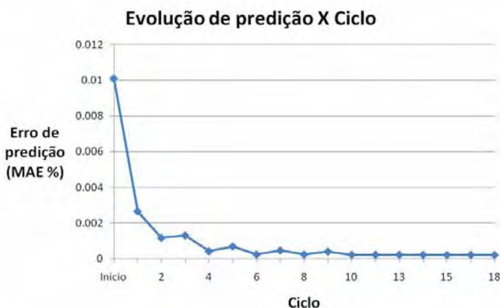
Figura 39 – Evolução de desempenho das melhores redes a cada ciclo – aplicação do método a curvas sintéticas – 30 casos de treinamento.
