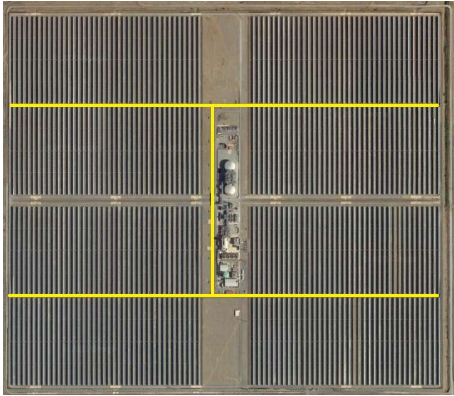
Figura 22 - Imagem de satélite do campo solar na configuração “H”, com destaque em amarelo para os headers .
