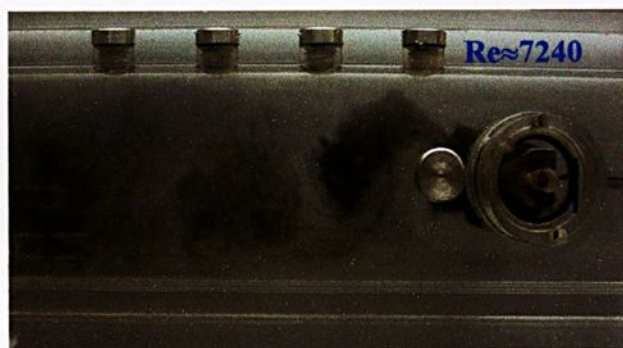
Figura 5.29 - Esteira de vórtices formado à jusante de um cilindro trapezoidal reto, sem fenda (vista superior).
