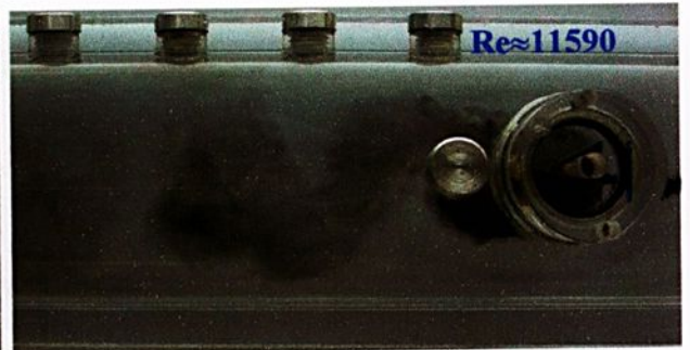
Figura 5.31 - Esteira de vórtices formado à jusante de um cilindro triangular, sem fenda, em função de Reynolds (vista superior).
