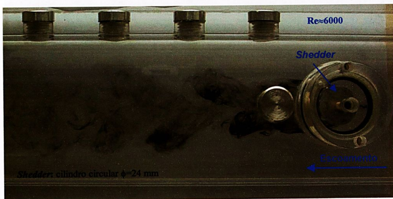
Figura 5.10 - Visualização da esteira de vórtices de von Kármán a jusante de um cilindro circular com fenda (vista superior).
