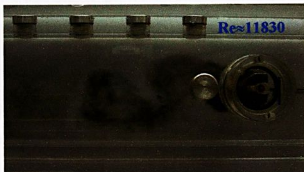
Figura 5.29 - Esteira de vórtices formado à jusante de um cilindro trapezoidal reto, sem fenda (vista superior).
