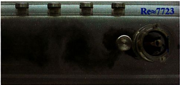
Figura 5.37 - Esteira de vórtices formado à jusante de um cilindro com perfil T chanfrado, sem fenda, em função de Reynolds (vista superior).
