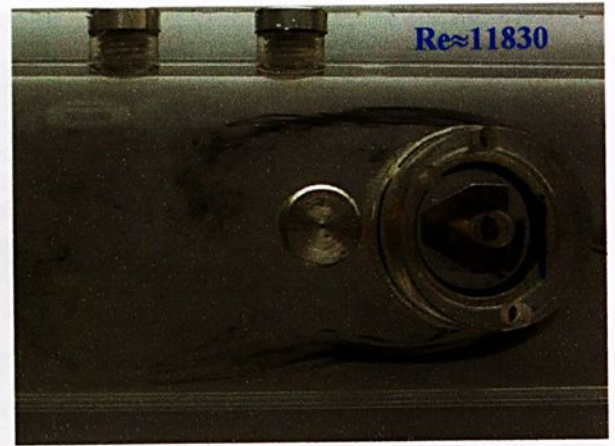
Figura 5.30 - Visualização do vórtice de ferradura a jusante de um cilindro trapezoidal reto, sem fenda, em função de Reynolds (vista superior).
