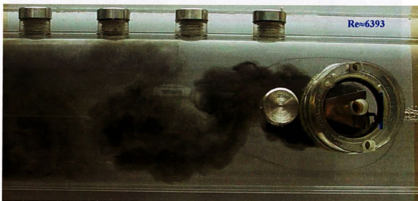
Figura 5.25 - Esteira de vórtices formado à jusante de um cilindro trapezoidal, sem fenda (vista superior).
