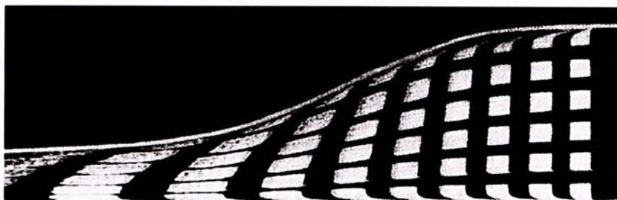
Figura 3.19 - Deformação do fluido ao longo de uma contração (Schraub et al. , 1965).
