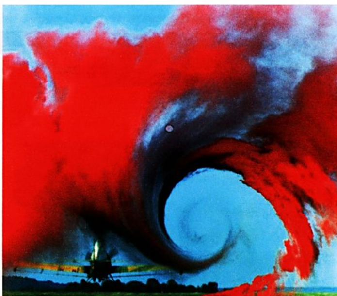
(b) Vórtice de ponta de asa num avião pulverizador: neste caso o inseticida torna o vórtice visível.
