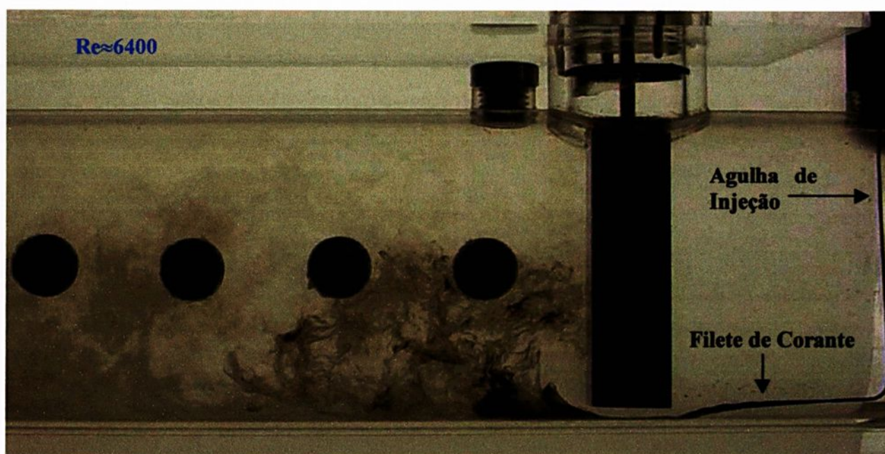
Figura 5.17 - Influência do “gap” no escoamento a jusante de um cilindro trapezoidal (vista lateral).
