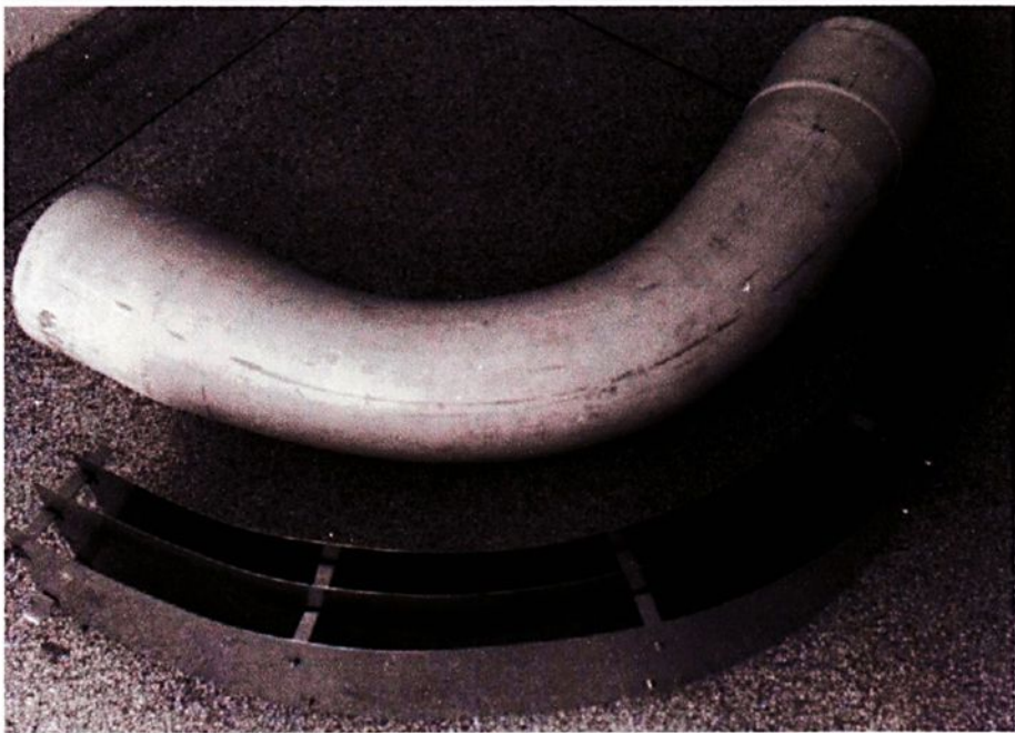
Figura B.7 - Direcionadores de escoamento instalados no interior da curva longa de 8".
