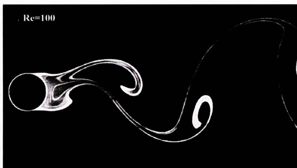
Figura 3.15 - Exemplo de visualização de escoamento em meio líquido (Dalton et al. , 2001).
