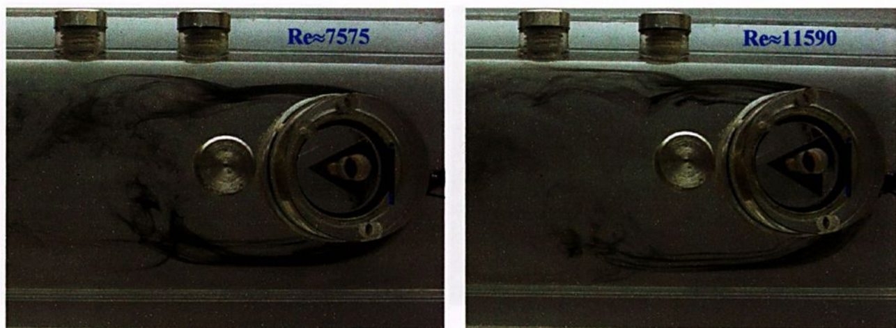
Figura 5.32 - Visualização do vórtice de ferradura a jusante de um cilindro triangular, sem fenda, em função de Reynolds (vista superior).
