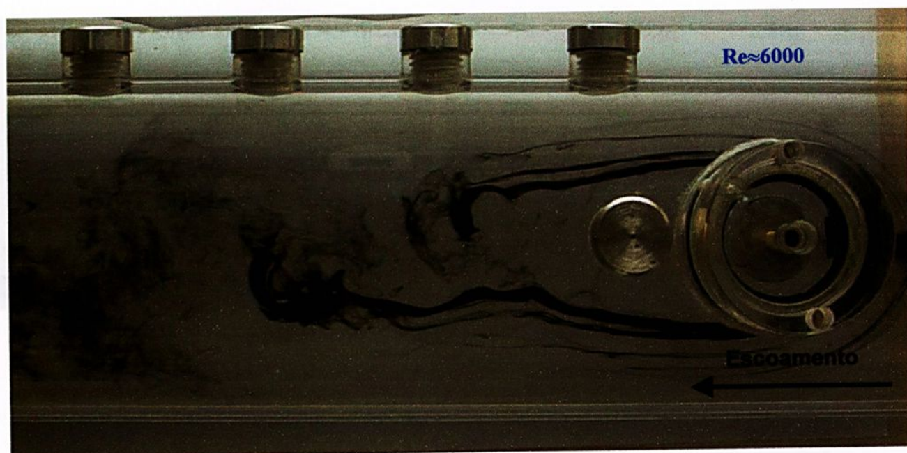
Figura 5.12 - Visualização do vórtice de ferradura a jusante de um cilindro circular com fenda (vista superior).
