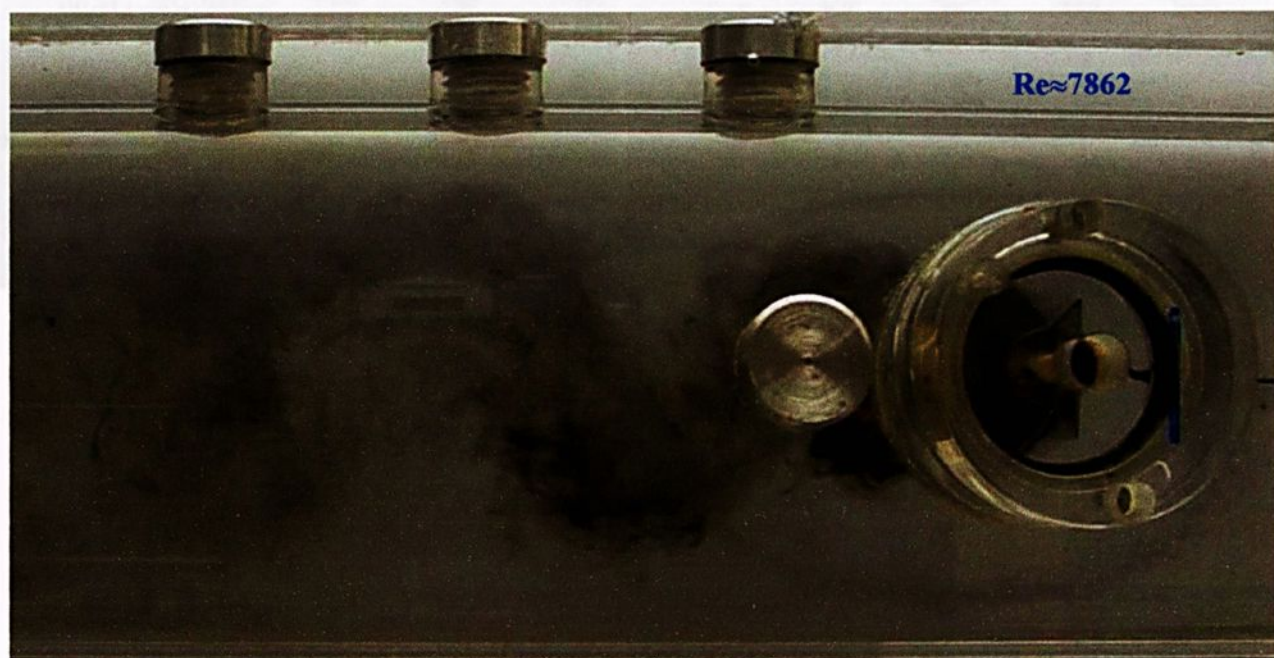
Figura 5.33 - Esteira de vórtices formado à jusante de um cilindro otimizado, sem fenda (vista superior).
