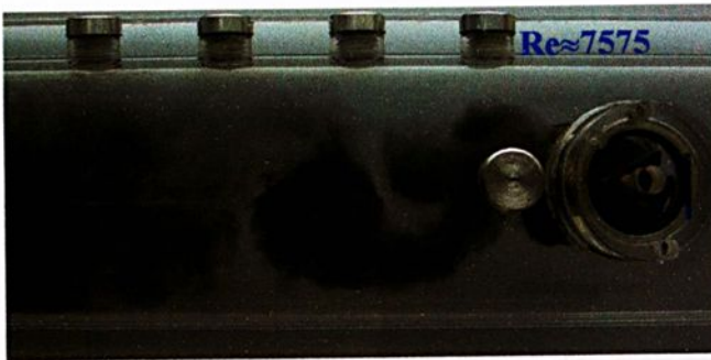
Figura 5.31 - Esteira de vórtices formado à jusante de um cilindro triangular, sem fenda, em função de Reynolds (vista superior).
