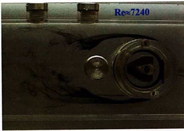
Figura 5.30 - Visualização do vórtice de ferradura a jusante de um cilindro trapezoidal reto, sem fenda, em função de Reynolds (vista superior).
