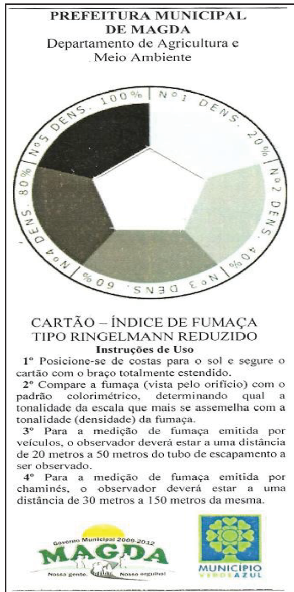
Figura 26: Escala de Ringelmann utilizada na inspeção dos veículos pela Prefeitura de Magda. Fonte: Prefeitura Municipal de Magda, 2010.
