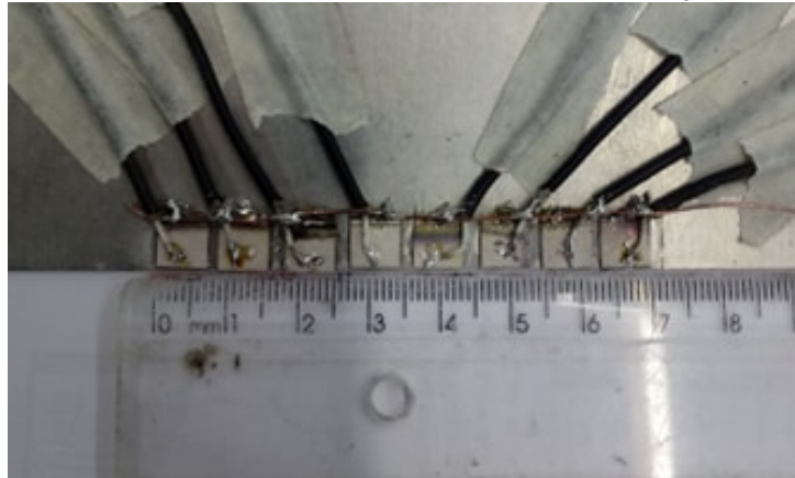
Figura 24: Array de transdutores montado para a formação das imagens.
