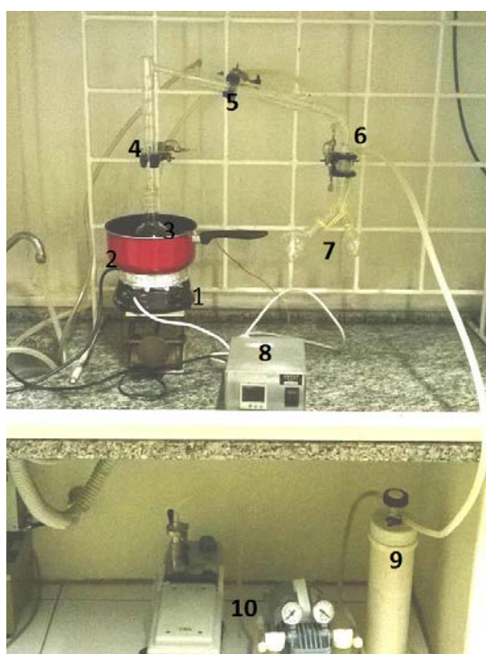
Figura 6 – Montagem experimental do sistema para a destilação da o-anisidina
