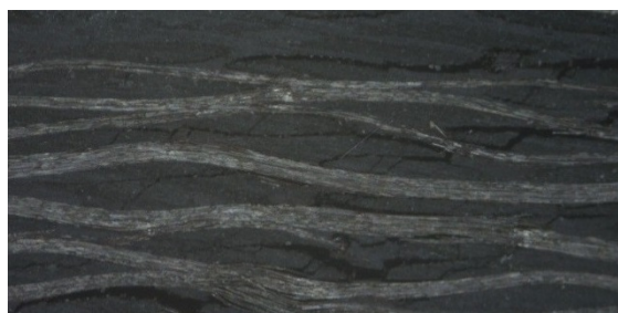
Figura 25 – Seção transversal do compósito depois do ensaio de cisalhamento interlaminar (sem condicionamento)
